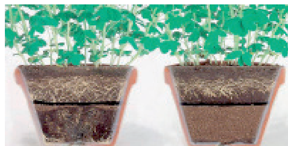
Στεγάνωση χωρίς τη χρήση του αντιριζικού πρόσθετου Preventol B5 και με τη χρήση αυτού.
